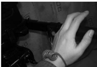
Надёжно закрепите трос аварийного выключателя зажигания за одежду, за руку или за ногу. Затем установите блокирующую пластинку с другого конца троса на аварийный выключатель зажигания.
